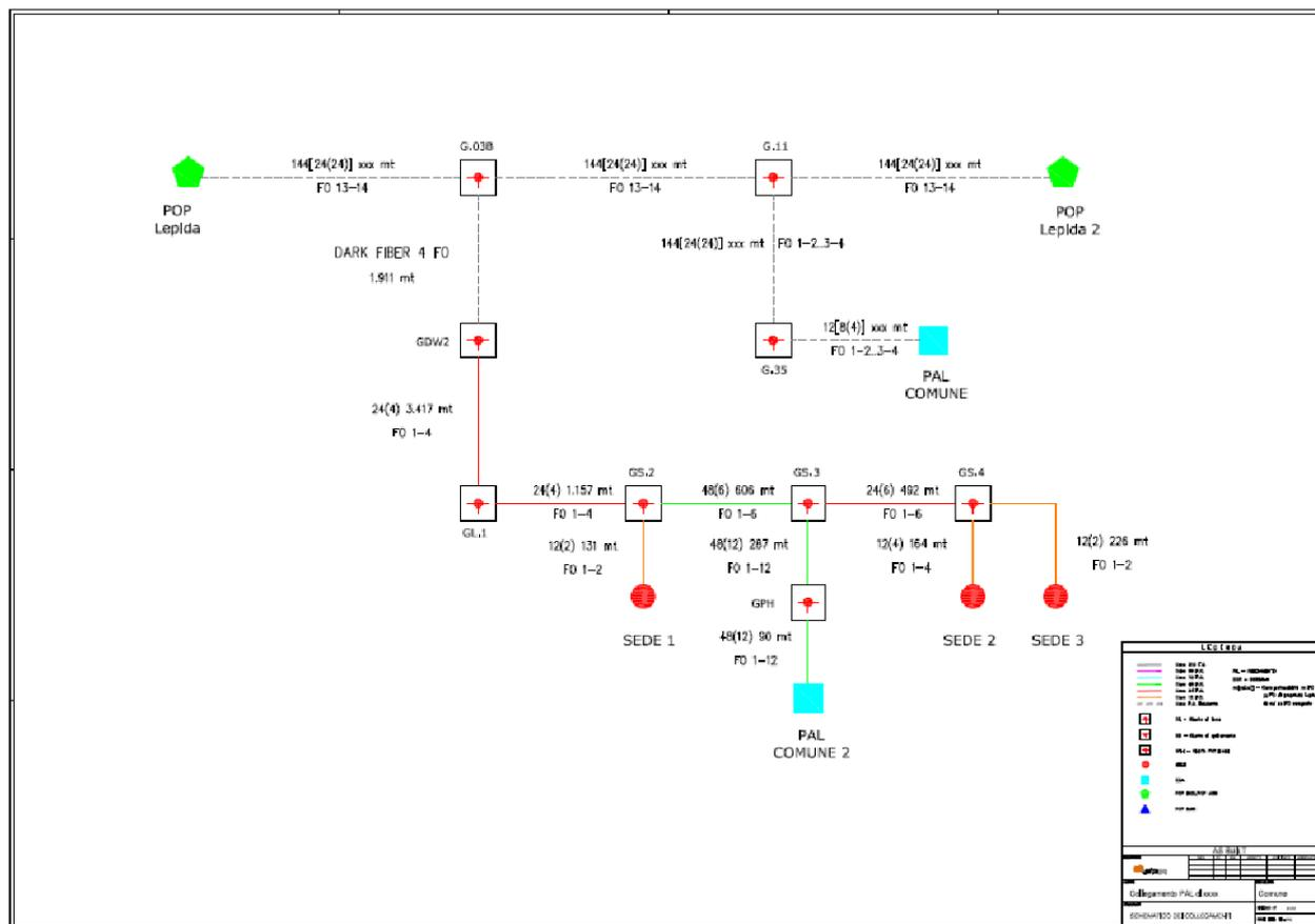
Figura 2 - esempio Schematico di collegamento
