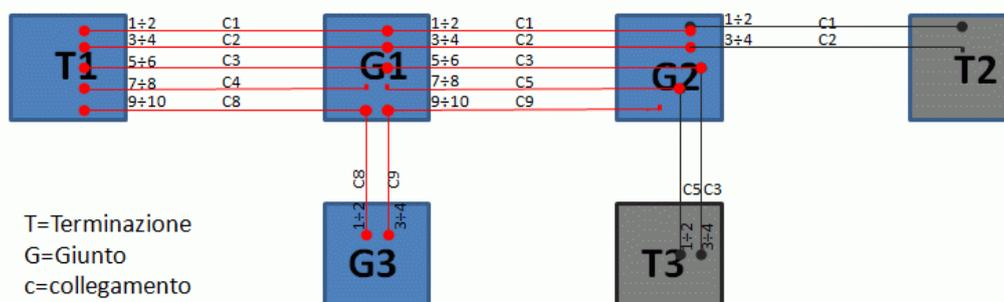
Figura 10: ESEMPIO DI VARIAZIONE DELLA RETE, CON L'AGGIUNTA DEL GIUNTO G3 E DEI RISPETTIVI NUOVI COLLEGAMENTI (C8 E C9), E PORZIONE CORRISPONDENTE DELLA RETE DI CUI FORNIRE LA DOCUMENTAZIONE RELATIVA: T1, G1, G2, G3.
