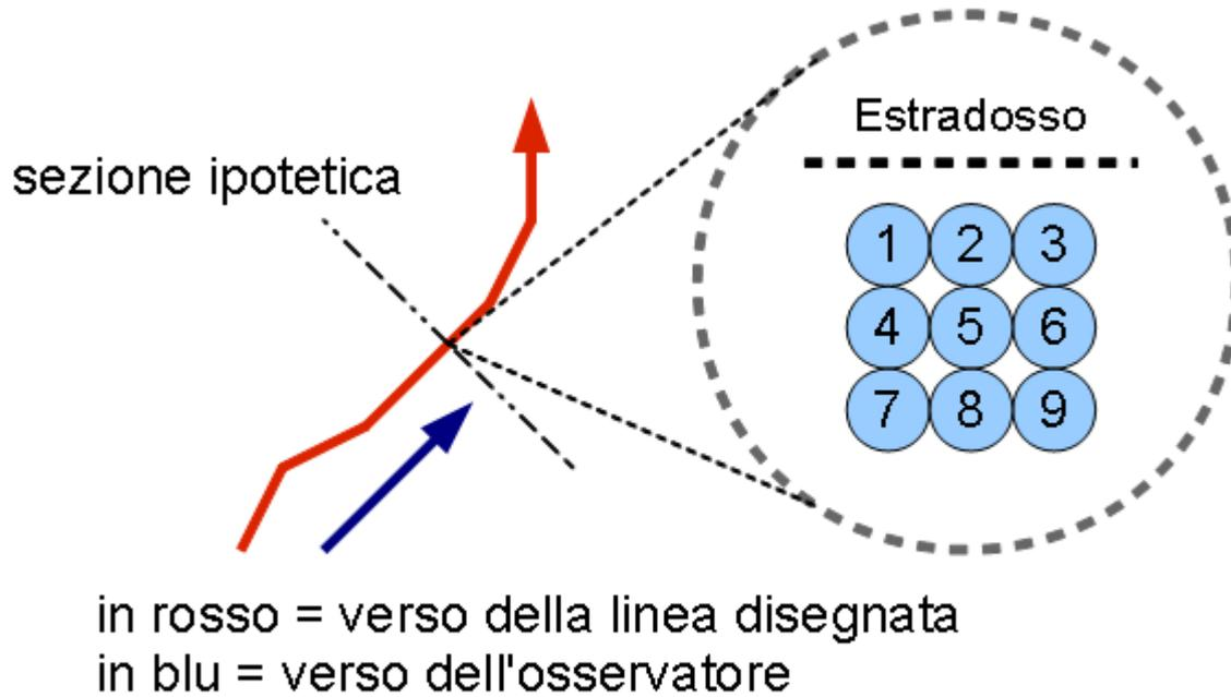
Figura 11: ESEMPIO DI NUMERAZIONE DELLA POSIZIONE DEI TUBI IN UNO SCAVO
