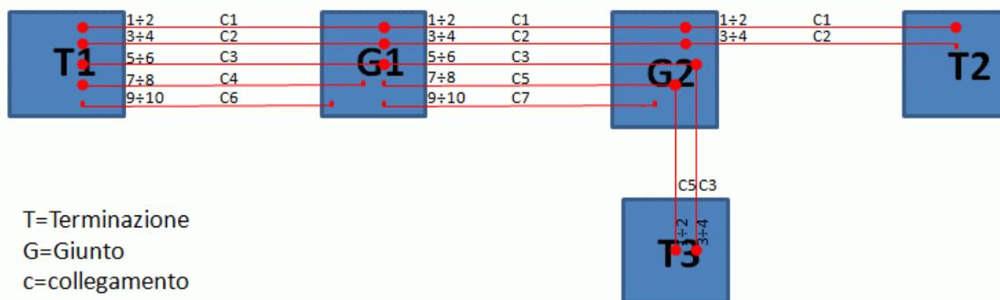
Figura 9: ESEMPIO SCHEMATICO DI ALCUNI TIPI DI COLLEGAMENTI. I COLLEGAMENTI C1 E C3 SONO COSTITUITI DA COPPIE DI FIBRE BITERMINATE. I COLLEGAMENTI C2 , C4 E C5 SONO COSTITUITI DA COPPIE DI FIBRE MONOTERMINATE. I COLLEGAMENTI C6 E C7 SONO COSTITUITI DA COPPIE DI FIBRE NON TERMINATE.
