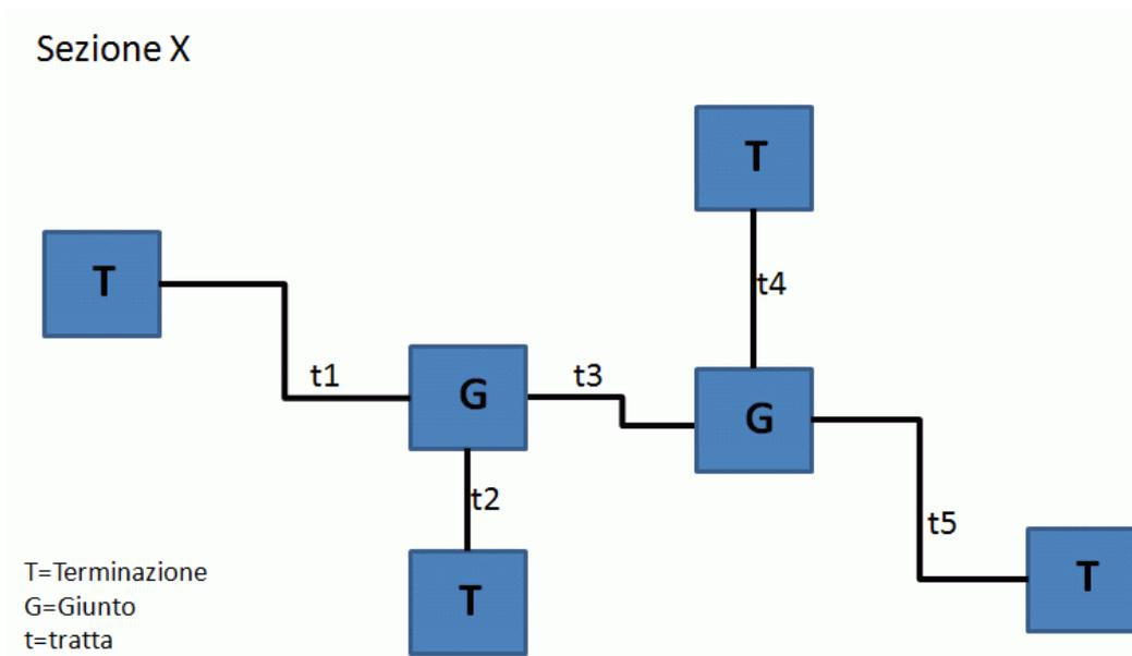
Figura 8: esempio schematico di sezione
