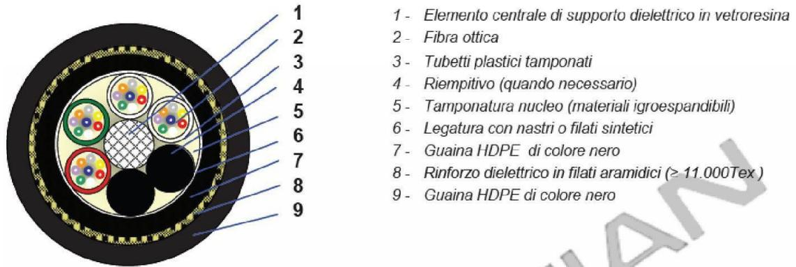
Figura 5 - Sezione di cavo autoportante a 48 fibre ottiche SMR per posa su palificata
