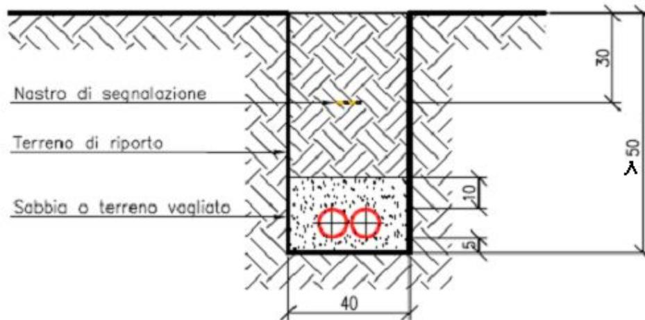
Figura C - Sezione tipo scavo tradizionale su terreno
